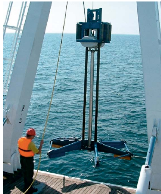
Abb. 17: Vibrationskerngerät im Einsatz in der Ostsee (Foto: FUGRO-Consult GmbH, Greifswald)
